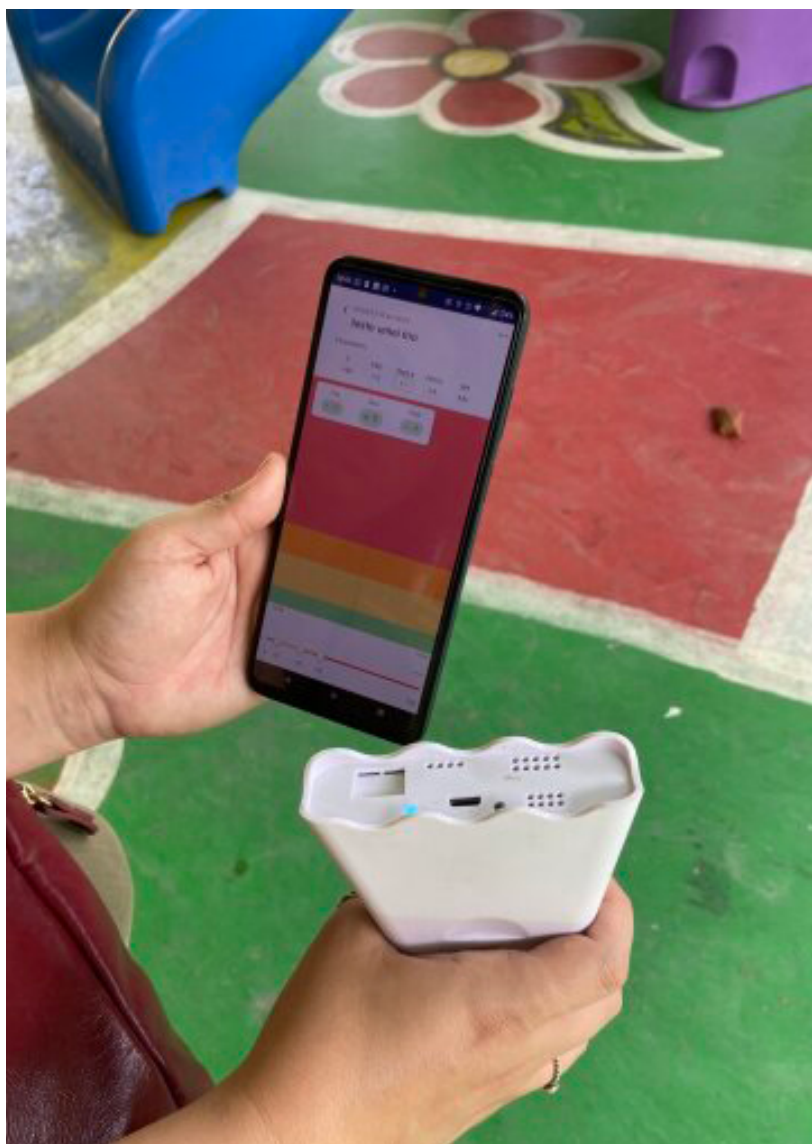
Sensor de baixo custo para monitoramento da qualidade do ar que é utilizado no projeto sendo testado.
